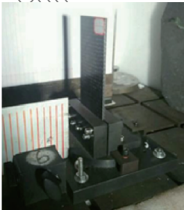
图 2 空气炮试验夹具和试验件示意图
