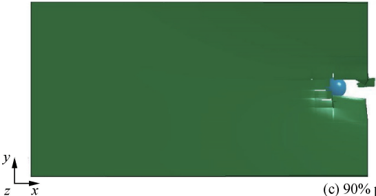
图 12 三维四向编织复合材料弹道冲击数值模拟和试验结果
