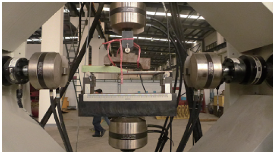
图 4 四点弯曲疲劳试验安装图
