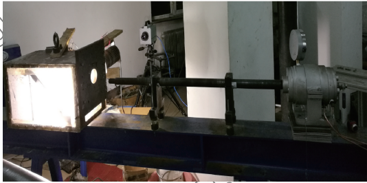
图 1 一级气炮装置 Fig. 1 Device of one-stage gas gun
