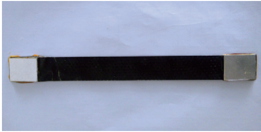
图2 玄-碳纤维混杂平纹织物增强环氧树脂基复合材料 标准拉伸试件
