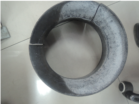
图 1 试车后 C/C-SiC 喷管内层照片
