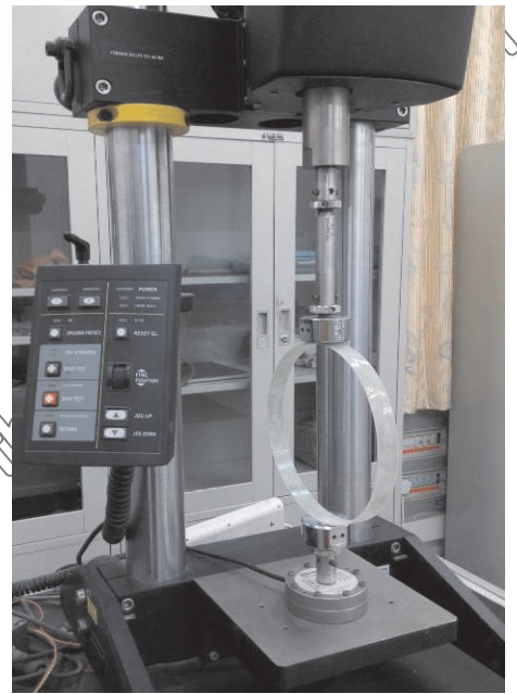
图 2 使用高精度的 Instron 5848 型微型材料试验机测量试样
