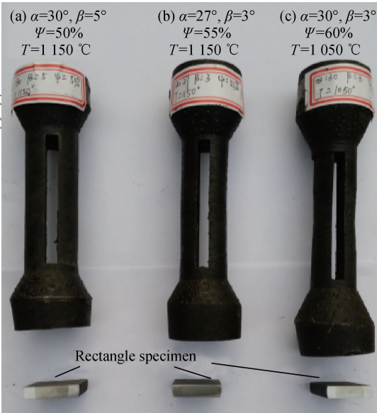
图 6 线切割后经处理的 42CrMo/Q235 复合材料轧件 Fig. 6 Disposed 42CrMo/Q235 composite laminated shaft after wire-cutting
