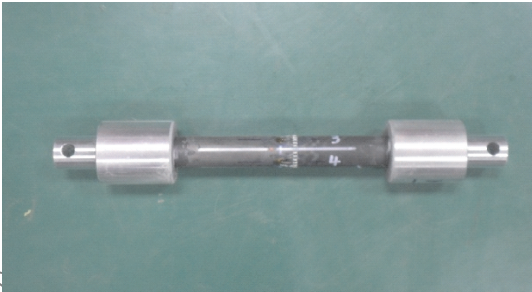
图 2 复合材料圆管 Fig. 2 Composite circular tube
